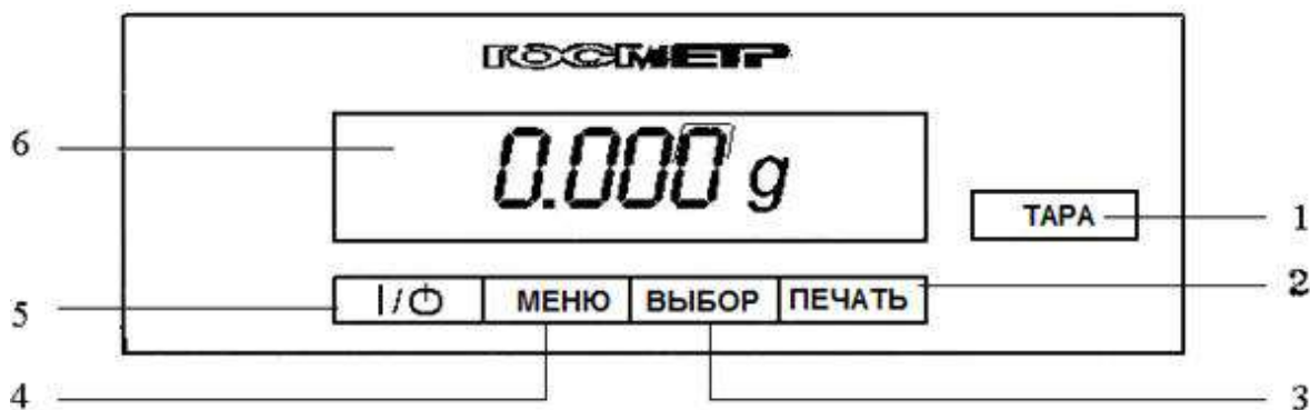
1 - клавиша TARA, 2 - клавиша ПЕЧАТЬ, 3 - клавиша ВЫБОР, 4 - клавиша МЕНЮ, 5 - клавиша вкл/выкл «I/O», 6 - дисплей.
