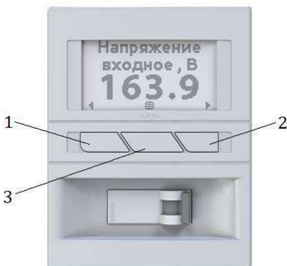
Рисунок 12. Расположение кнопок управления на панели управления
