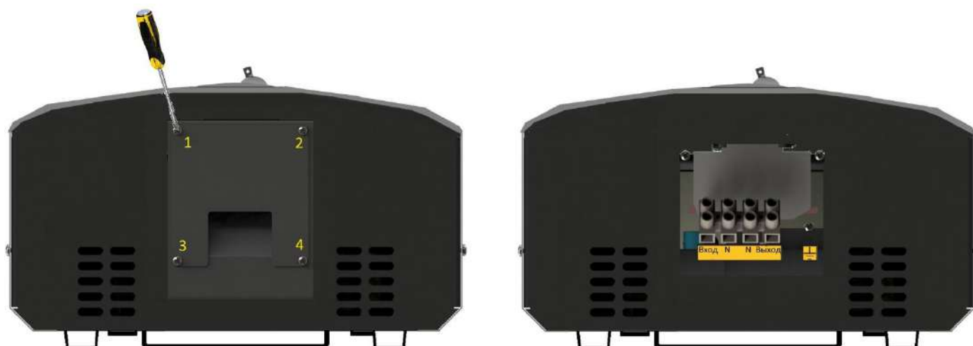
Рисунок 11. Схема снятия защитной крышки снизу корпуса стабилизатора
