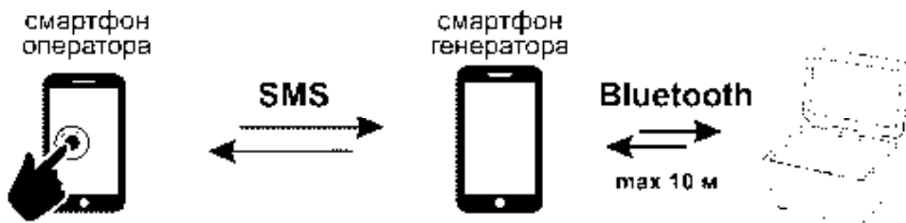
Рисунок 2.8 – Организация дистанционного управления генератором
