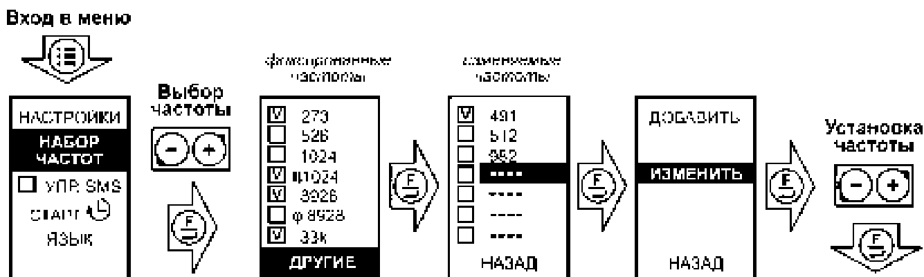
Рисунок 2.2 – Меню. Набор частот. Изменение частоты
