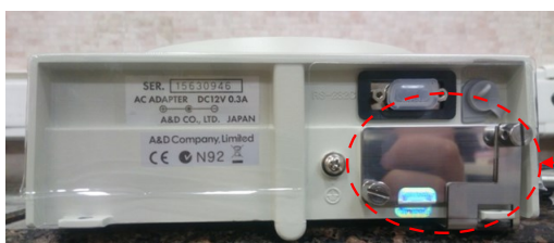
Рисунок 2 - Схема пломбировки весов от несанкционированного доступа
