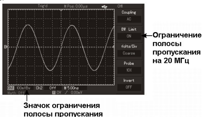
Рисунок 2-5. Вид дисплея при ограничении полосы пропускания
