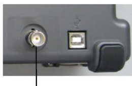
Выход сигнала функции PASS/FAIL на задней панели осциллографа
