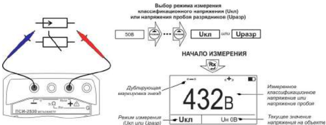
Рисунок 2.10 - Измерение классификационного напряжения или напряжения пробоя разрядников
