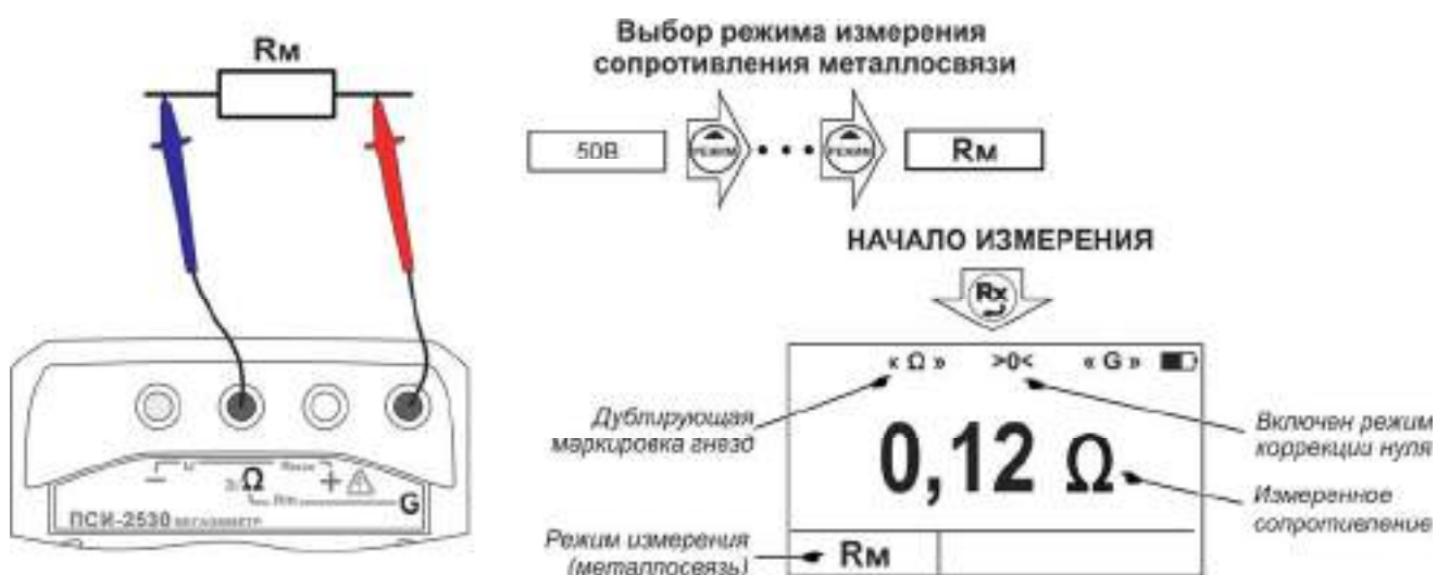
Рисунок 2.8 - Измерение сопротивления металlosвязи
