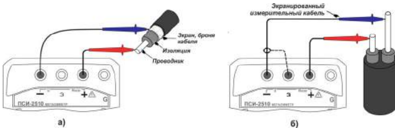
Рисунок 2.11 - Измерение сопротивления изоляции
