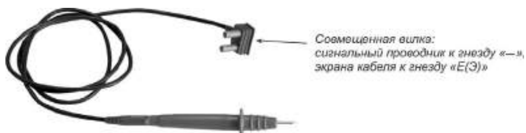
Рисунок 1.4 - Внешний вид экранированного измерительного кабеля РАПМ.685631.001
