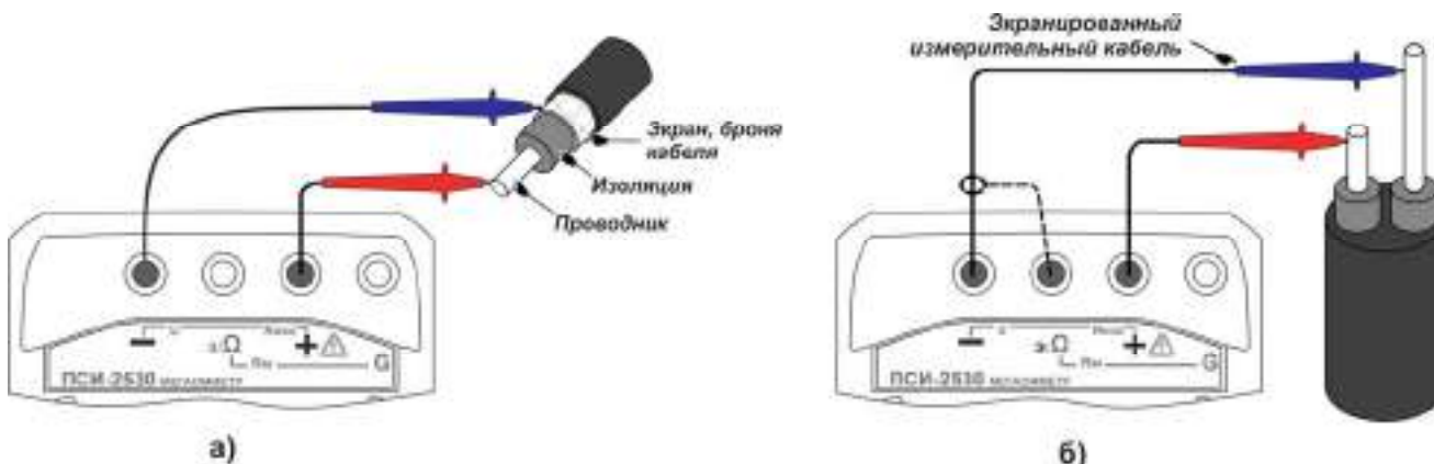
Рисунок 2.5 - Измерение сопротивления изоляции кабеля
