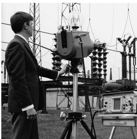
Рисунок 14.2 1969 г.: Thermovision модель 661. Эта камера весила около 25 кг, осциллограф – 20 кг, а штатив – 15 кг. Кроме того, оператору требовался генератор переменного напряжения на 220 В и сосуд на 10 л с жидким азотом. Слева от осциллографа находится фотоприставка Polaroid (6 кг).
