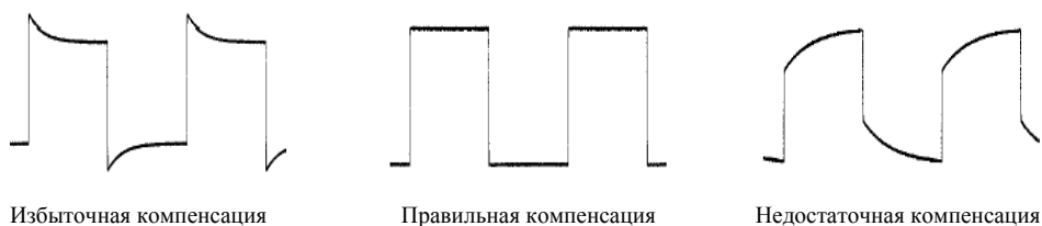
Рис. 1-10 Компенсация пробника
