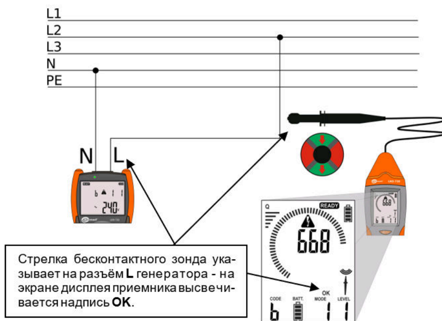
Идентификация разъёма L генератора
