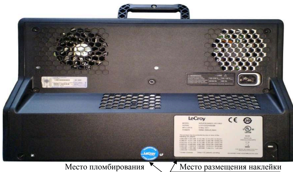
Рисунок 2 - Схемы для размещения наклейки и пломбировки от несанкционированного доступа
