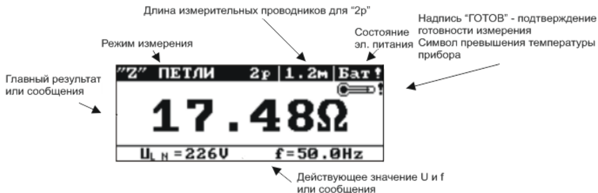
Вид экрана в режиме измерения полного сопротивления петли короткого замыкания (только главный результат)
