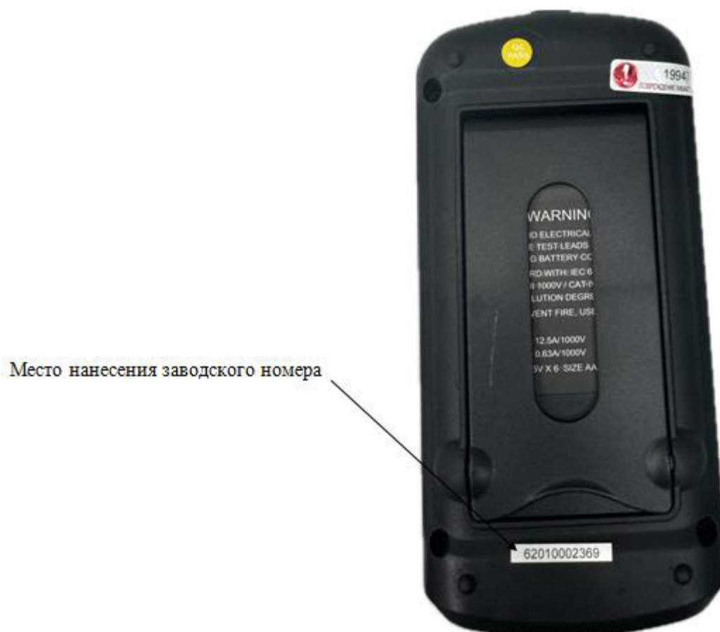
Рисунок 9 - Место нанесения заводского номера
