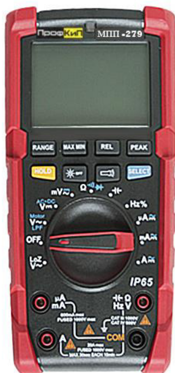
Рисунок 5 – Общий вид мультиметров переносных профессиональных ПрофКиП МПП-279
