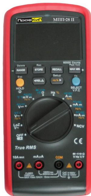
Рисунок 2 – Общий вид мультиметров переносных профессиональных ПрофКиП МПП-28II
