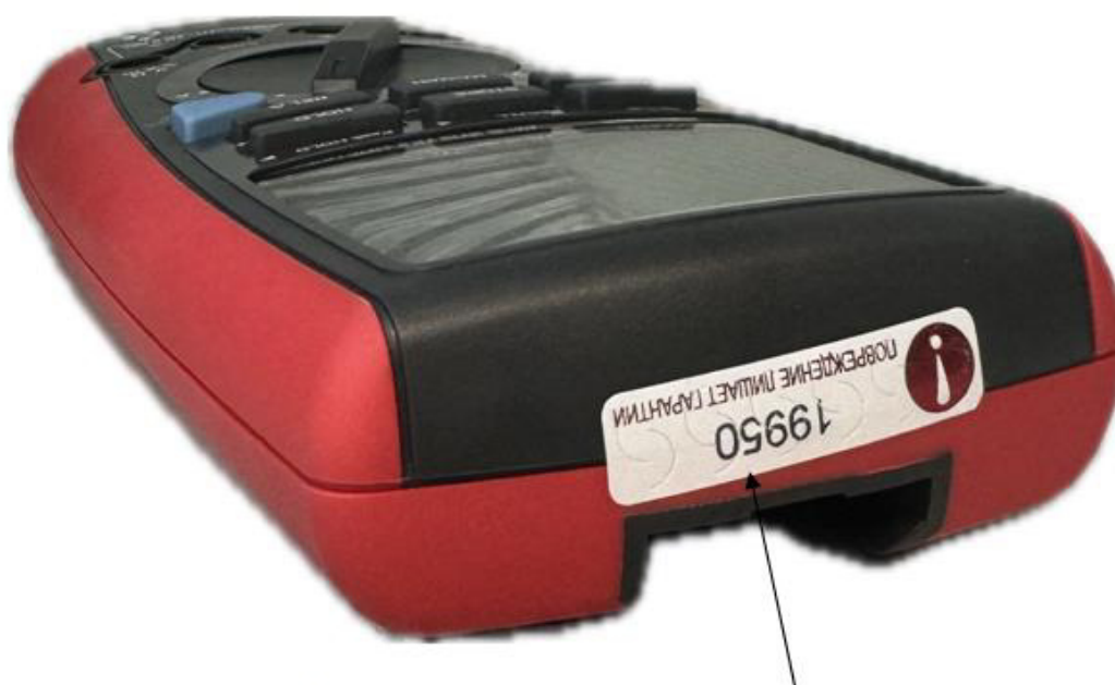
Рисунок 10 - Место пломбирования от несанкционированного доступа
