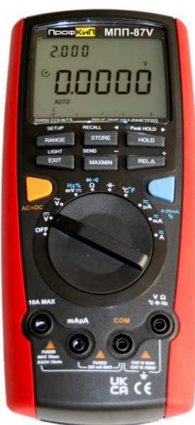
Рисунок 3 – Общий вид мультиметров переносных профессиональных ПрофКиП МПП-87V
