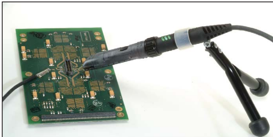
Пробник WaveLink с регулировкой TwinTips в держателе "FreeHand"
