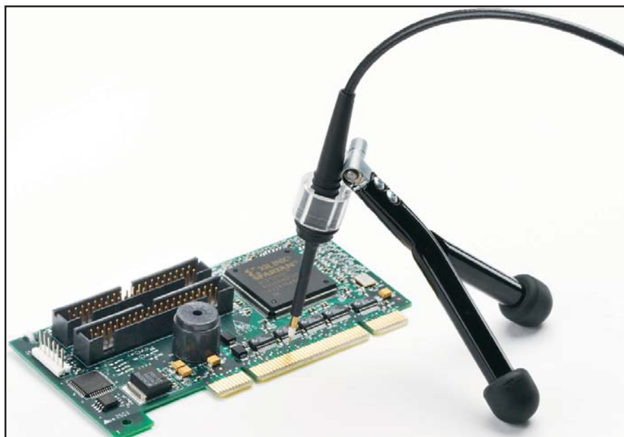
HFP пробник с оригинальным фиксатором "свободные руки"
