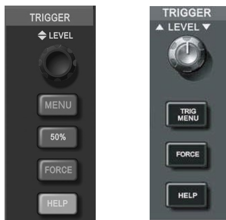
Рисунок 1-11. Зона управления запуском на панели управления осциллографов с 5,7-дюймовым дисплеем (слева) и 7-дюймовым дисплеем (справа)
