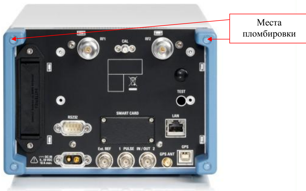
Рисунок 2 - Схема пломбировки от несанкционированного доступа
