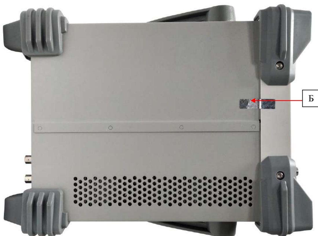
Рисунок 2 – Вид нижней панели генераторов, место пломбировки от несанкционированного доступа (Б)
