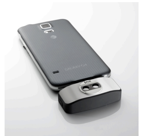
Рисунок 22.3 2015 г.: FLIR One, приложение для мобильных телефонов с операционной системой iPhone и Android. Вес: 90 г.
