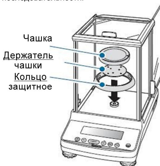
Рисунок 5 – Монтаж весов
