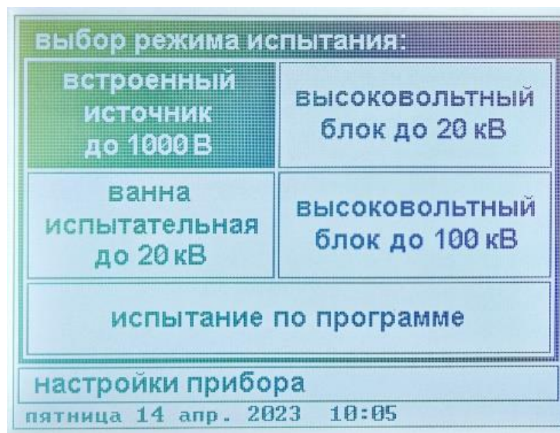
Рисунок 9 – Экран стенда в главном меню для модификации СКАТ-СВС-100-20Ц
