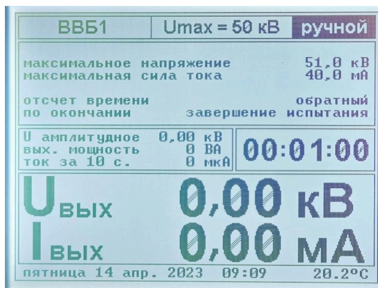
Рисунок 13 – Экран стенда при работе с внешним высоковольтным блоком при ручном управлении выходным напряжением
