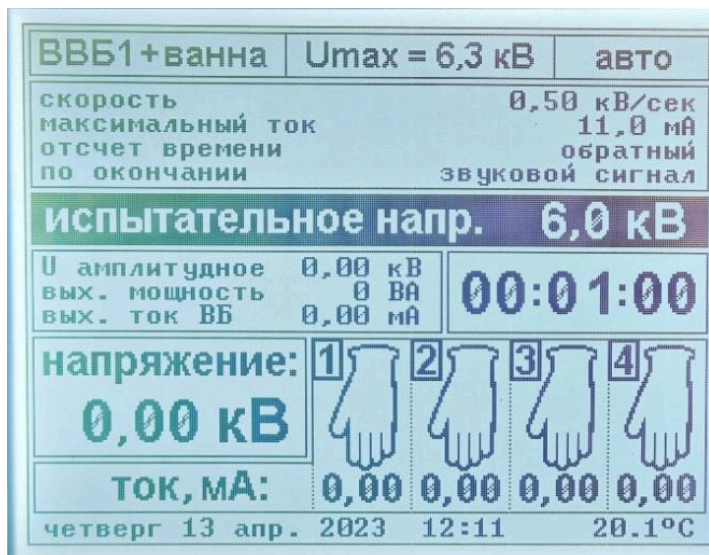
Рисунок 20 – Экран стенда при испытании перчаток
