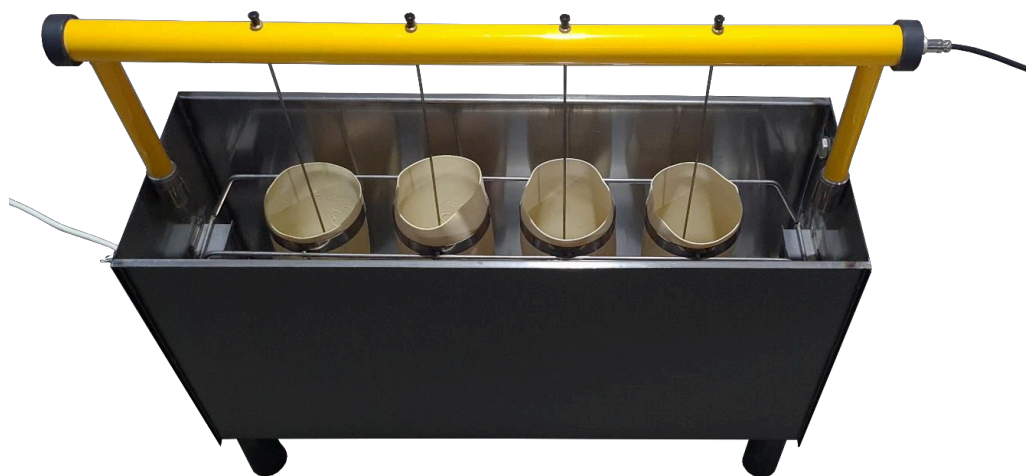
Рисунок 15 – Установка перчаток в ванну для испытания
