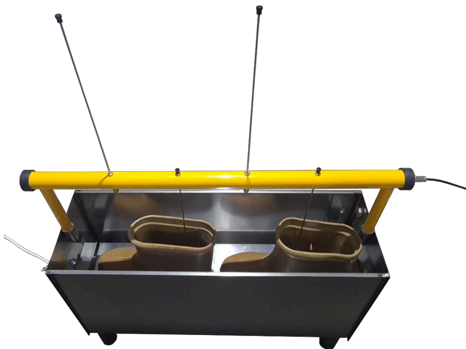
Рисунок 16 – Установка бот в ванну для испытания
