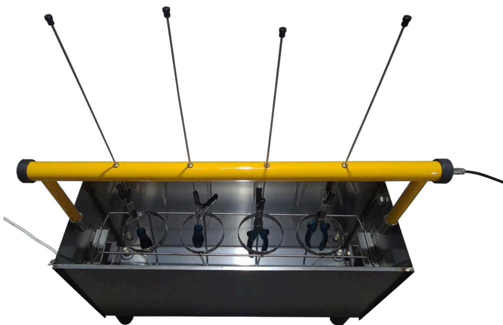
Рисунок 17 – Установка инструмента в ванну для испытания
