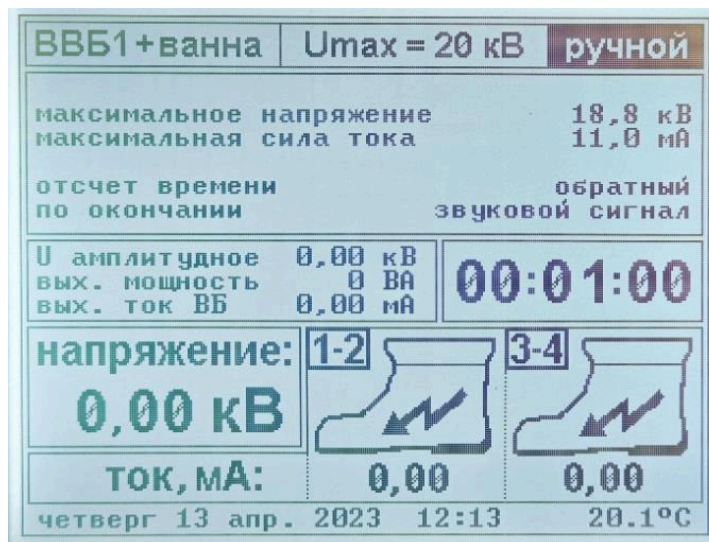
Рисунок 19 – Экран стенда при испытании бот
