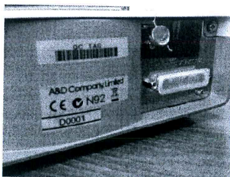
Рисунок 2 – Схема пломбировки весов от несанкционированного доступа
