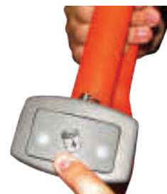
в) Уст новить б т рейный отсек в корпус, н д вить н отсек до ср б т ы в ния фикс тор
