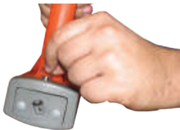
а) Выдвинуть фикс тор, освободить б т рейный отсек
