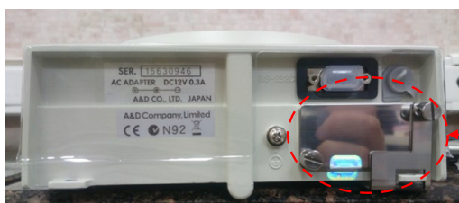
Рисунок 2 - Схема пломбировки весов от несанкционированного доступа
